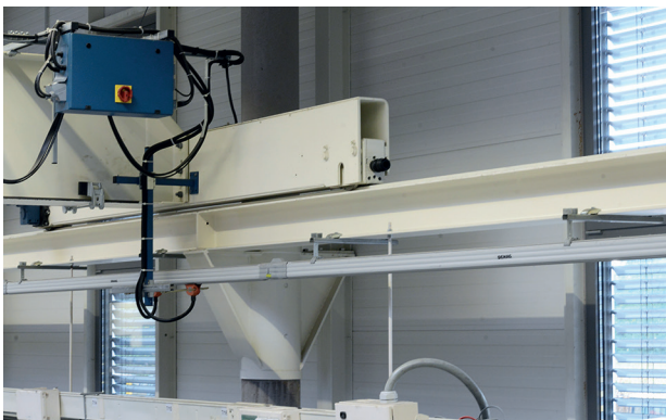
► Protección de parada de emergencia en el eje de desplazamiento de un cabezal móvil de husillo
